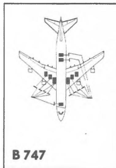
Figure 10 Disposition typique des sacs pneumatiques de levage
