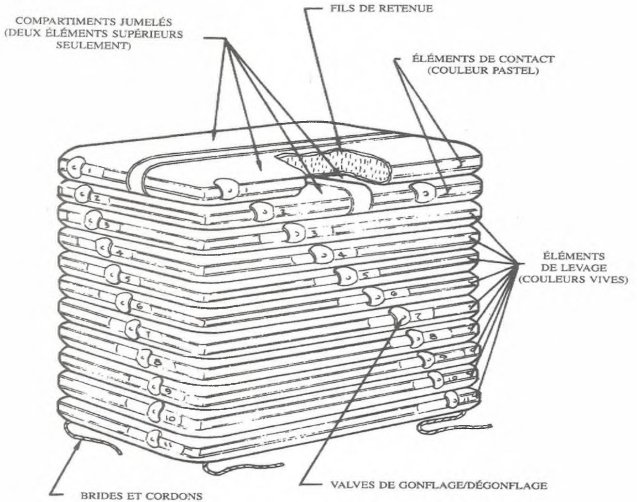
Figure 4 Sac pneumatique de levage à grande stabilité de 25 tonnes
