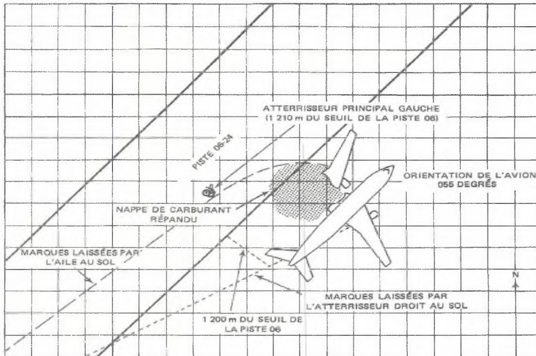
Figure 1 Exemple de Croquis d'un lieu d'accident
